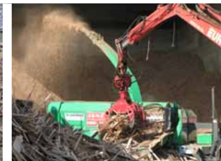
Broyage de bois en fin de vie
