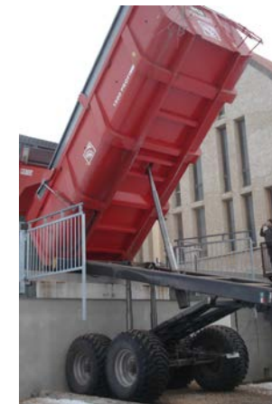
Benne élévatrice et basculante Chaufferie de Seyne-les-Alpes (04) - 550 kW
